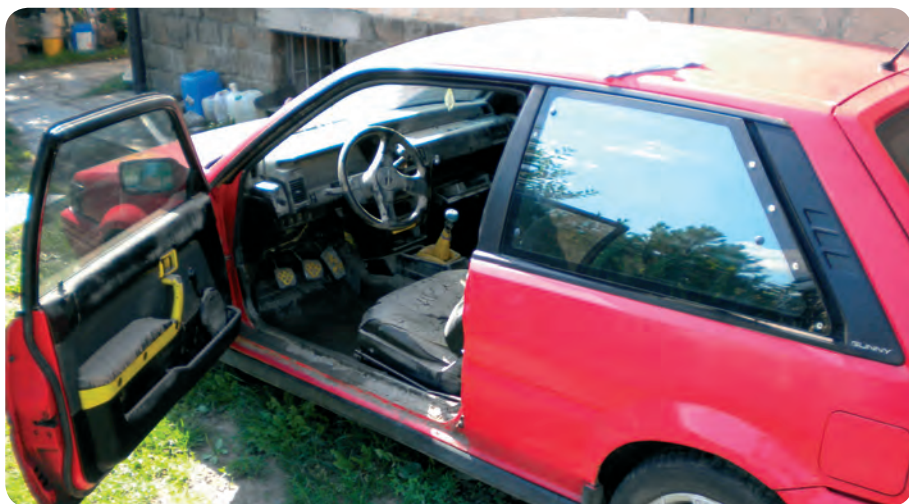
Zaplavený vůz nad úroveň motoru
